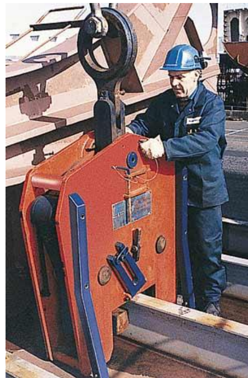
IPSE Cleme pentru ridicarea si transferul sectiunilor de nave foarte grele
